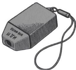
Рисунок 5.8 – Індивідуальний вимірювач дози ІД-11
