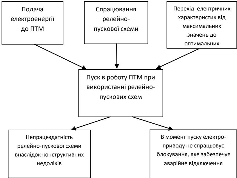
Рисунок 2.1. Схема підвищення надійності роботи електропривода енергоспоживаючих ПТМ
