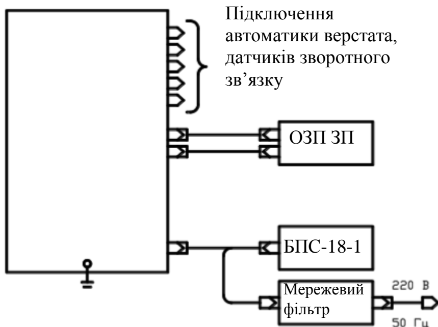
Рис. 2.1 – Схема з'єднань УЧПК «Електроніка НЦ-31»
